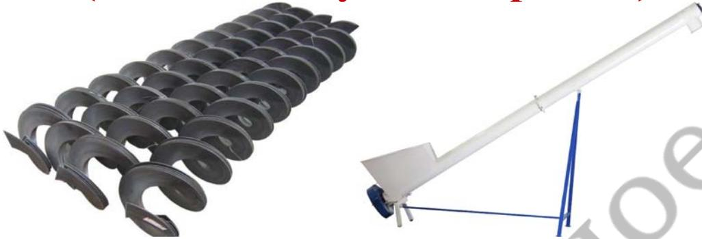
Транспортер секционный шнековый предназначен для перемещения зерна и сыпучих материалов в горизонтальном, наклонном и вертикальном направлениях.
