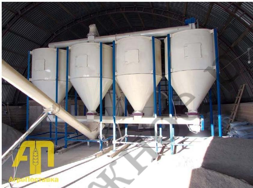
Бункер продукции накопительный БПН служит для накопления и кратковременного хранения сыпучих кормов и другого рассыпного и гранулированного продукта. Применяются в различных технологических линиях.
