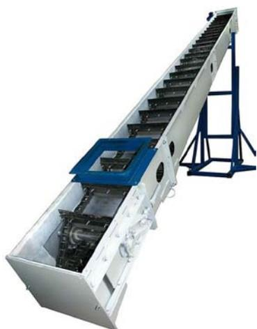
Цепной скребковый транспортер (ТЦС) — оборудование, применяемое в различных отраслях промышленности, как правило, для перемещения материалов, обладающих хорошей и средней сыпучестью. Конструкция цепных транспортеров представляет собой короб прямоугольного сечения, изготовленный из листовой стали. С одного конца транспортера расположена приводная станция, а с другого натяжная секция. Рабочим органом является цепь со скребками.
